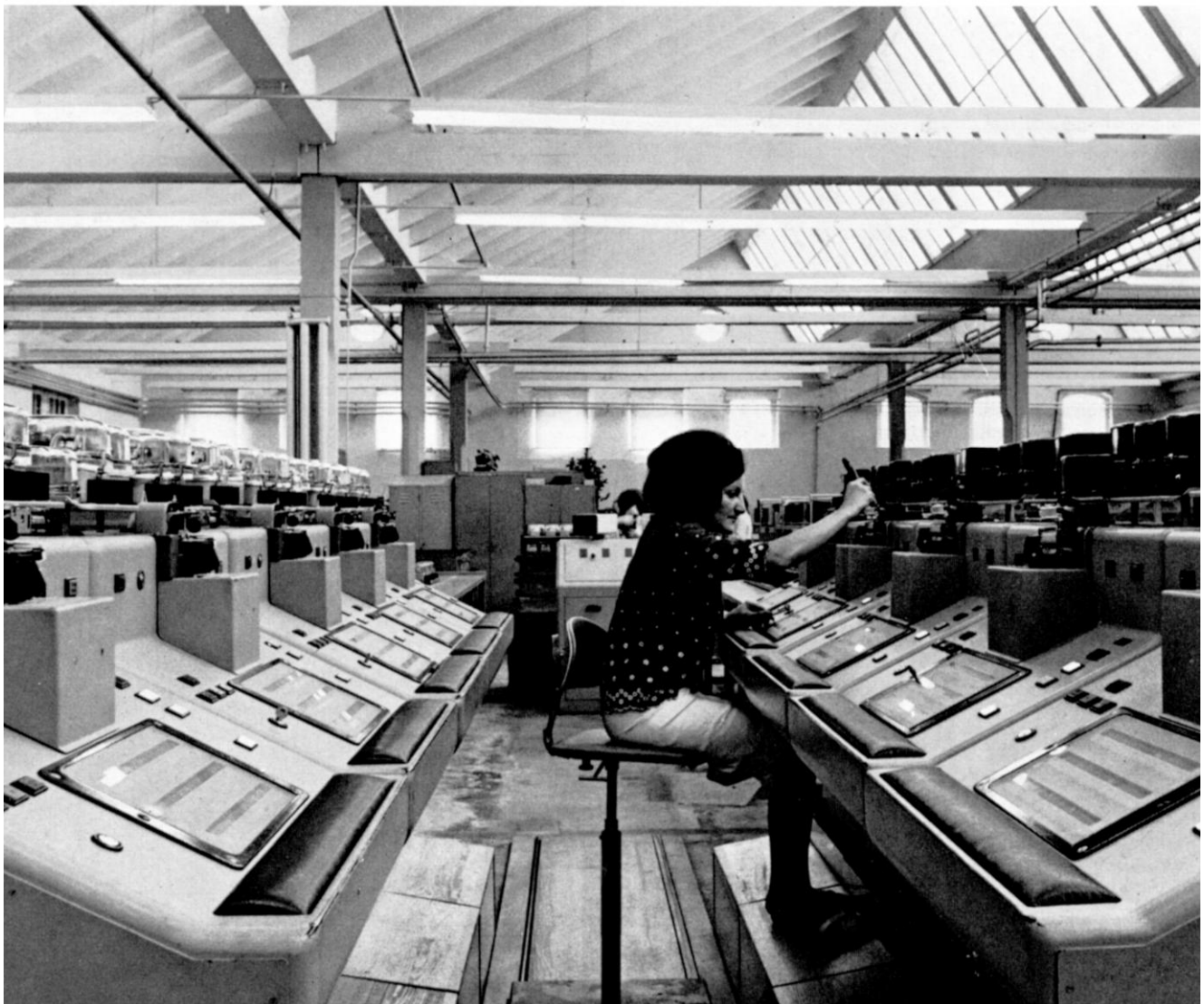
Auf den Halbautomaten werden die Zähler fertig geeicht. Hier Fräulein Valent an der Arbeit.
