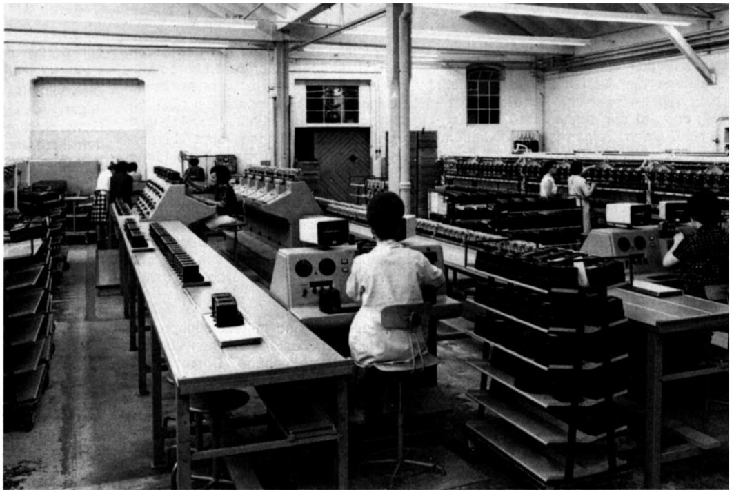
So präsentiert sich die neue Eichanlage für Einphasenzähler. Im Vordergrund die beiden Voreichstationen, im Hintergrund die 10 Halbautomaten und dazwischen die Tische mit den Rollbahnen.
