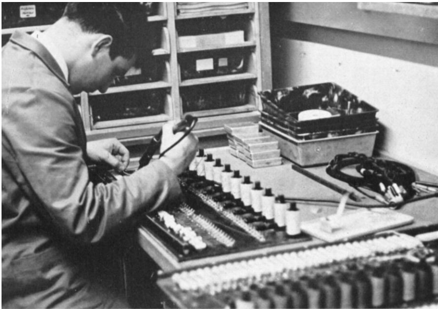
Hier werden nur Millionäre zugelassen, das heisst nur solche Schutzgaskontakte, die auch unter erschwerten Bedingungen mindestens 1 Million Schaltungen schadlos überstehen. Herr Freimann verdrahtet hier eine improvisierte Prüfeinrichtung, die es ermöglichen wird, die Millionen von dem gewöhnlichen Volk zu unterscheiden.
