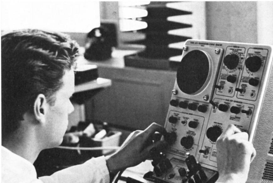
Hals- und Beinbrüche oder gar schleichende Krankheiten gibt es auch bei den Transistoren. Nur braucht es besondere Instrumente, um sie sichtbar zu machen. Herr Zehnder untersucht hier einen verdächtigen Patienten mit dem sogenannten Curve-tracer.
