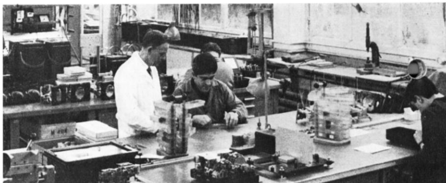
Herr Schäfer instruiert Herrn Macaluso bei der Montage der Eichzählwerke.
