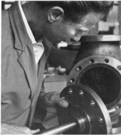
Herr Joseph Gondi, ein bei LG tätiger Ungar, beschäftigt sich hier mit der Kontrolle eines Durchlaufventiles. Mittels des Prüfdornes soll festgestellt werden, ob die Bohrung des Flansches mit der Bohrung des Gehäuses genau fluchtend ist.
