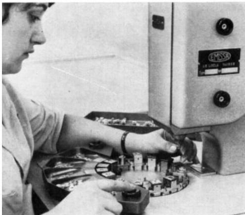
Fräulein Ecoretti öffnet die Spannzange durch Betätigung eines Schalters, nimmt mit der linken Hand eine fertigmontierte Trommelachse weg und legt sie in einen Behälter (bisherige Arbeitsmethode)
