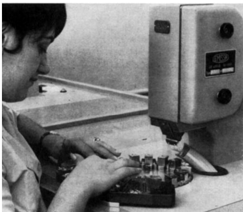
So präsentiert sich die geänderte Maschine. Die beiden Schalter auf dem Materialbehälter wurden entfernt und der fertige Bestandteil fällt automatisch in ein Rohr und durch dieses in den unter dem Maschinentisch liegenden Auffangbehälter.
