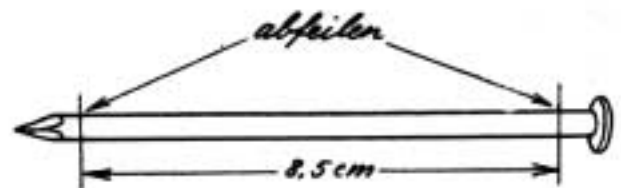
Abb. 8. Als Motorwelle dient ein grosser Nagel, dessen Spitze und Kopf abgefeilt werden
