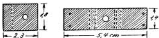
Abb. 9. Links: Form der beiden Bleche für den Stromabnehmer. Rechts: Blechstreifen zum Befestigen des Ankerkerns am Stromabnehmerhölzchen
